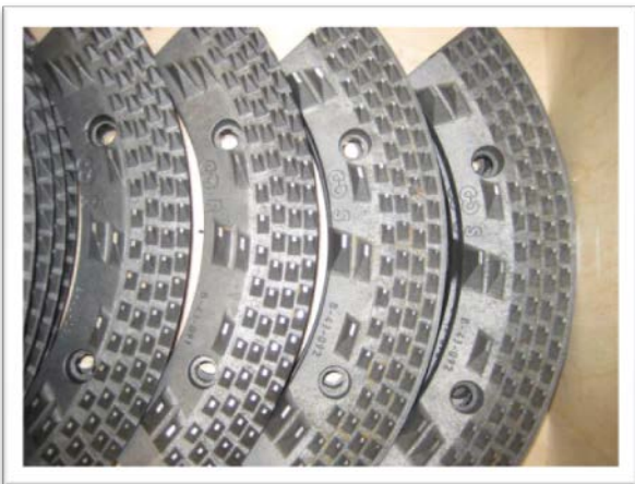
Figur 9. Dispergerarens stålskivor som sönderdelar materialet. (Foto: Uppsala Vatten och Avfall)
