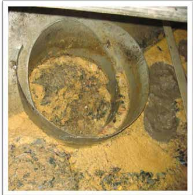
Figur 18. I bioseparatorn bräddas substratet för att pumpas till bufferttanken. (Foto: Johan Yngvesson)
