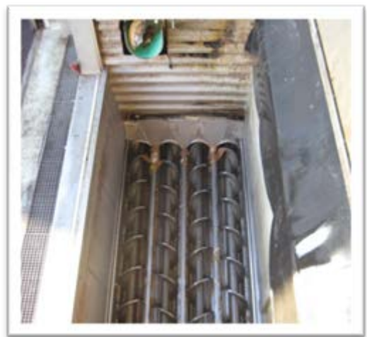
Figur 8. Buffertficka där blandningen av det rena organiska materialet sker. (Foto: Uppsala Vatten och Avfall)
