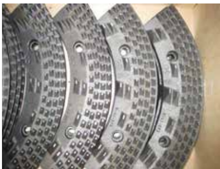
Figur 3. Dispergeringsringar. (Foto: Uppsala Vatten och Avfall) Figure 3. Dispersion rings. (Photo: Uppsala Vatten och Avfall)
