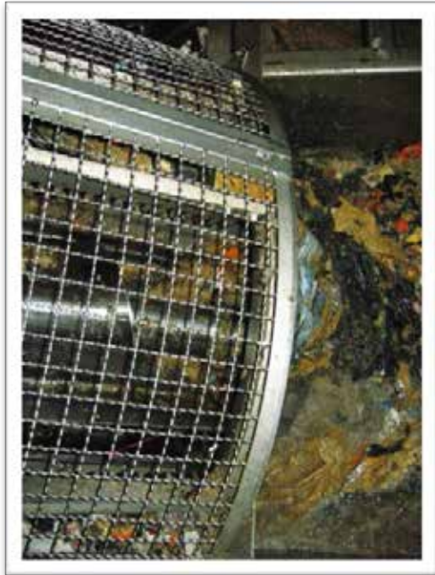
Figur 17. Bioseparatorn inleds med ett roterande silgaller som separerar flytande material såsom plast. (Foto: Johan Yngvesson)
