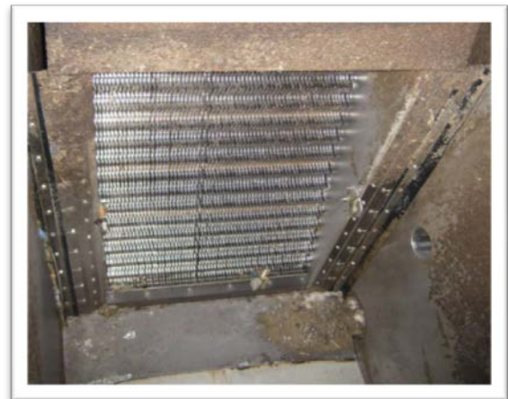
Figur 10. Silgallret som sitter efter sönderdelningen. (Foto: Uppsala Vatten och Avfall)
