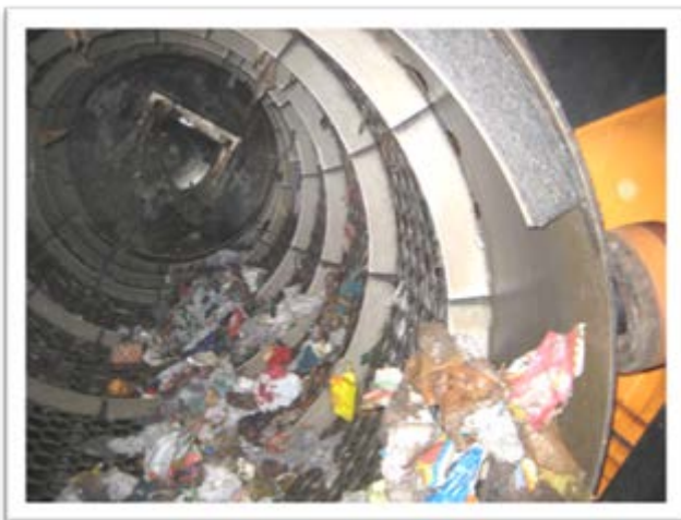
Figur 7. Bild på hur trumsikten avskiljer plast från matavfall. (Foto: Uppsala Vatten och Avfall)
