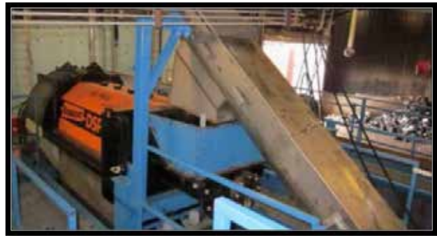
Figur 15. Materialet skruvas till en skruvpress. Det som inte passerar ett 10 mm såll kommer ut som rejekt. (Foto: Johan Yngvesson)
