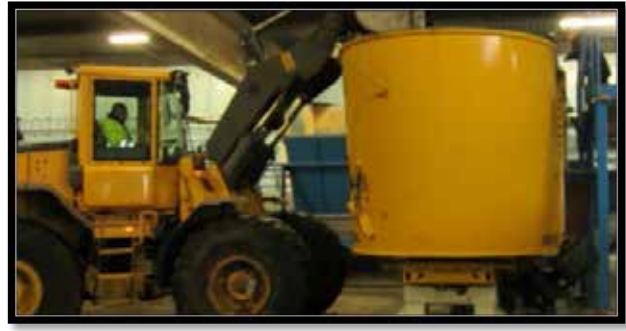
Figur 13. Påsarna lastas i en blandarvagn som är en ombyggd fodervagn med två omrörare. (Foto: Johan Yngvesson)
