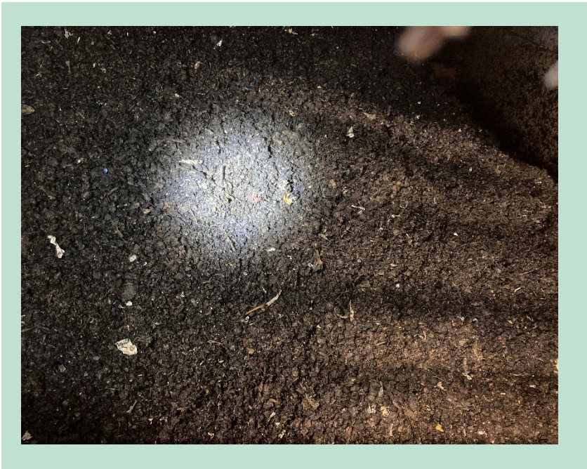
FIGUR 31. Rejekt fra forbehandlingsanlæg 5. Rejektet består primært af vandet slam og mindre plaststykker.
