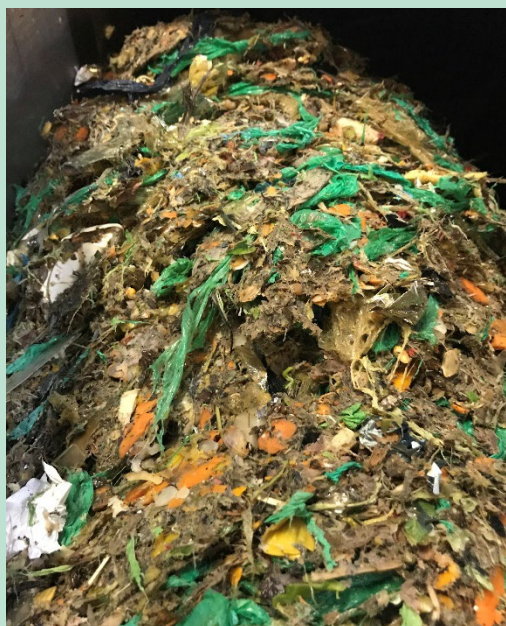
FIGUR 29. Rejekt fra biopulpproduktion ved forbehandlingsanlæg 4. Rejektet består primært af forskellige plastmaterialer.
