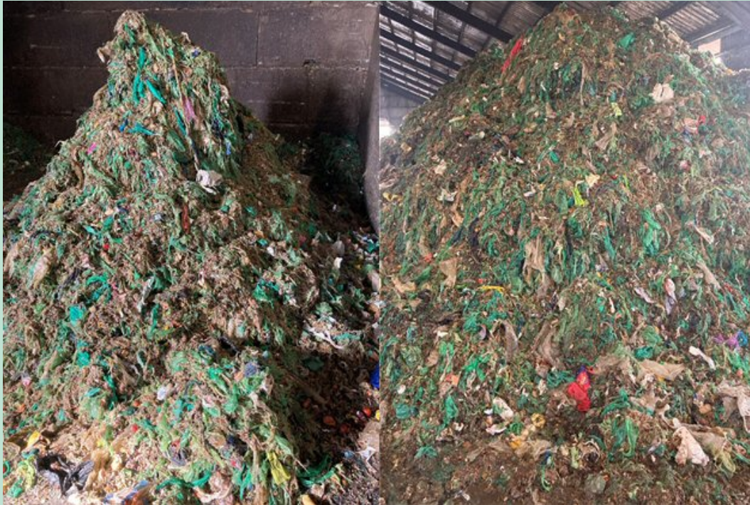
FIGUR 25. Afvandet rejekt fra biopulpproduktion ved forbehandlingsanlæg 1. Rejektet består primært af forskellige plastmaterialer.
