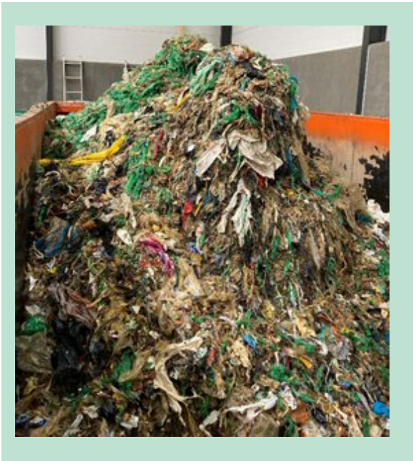
FIGUR 27. Afvandet rejekt fra biopulpproduktion ved forbehandlingsanlæg 2. Rejektet består primært af forskellige plastmaterialer, som genbruges i det omfang, det er muligt. Den resterende mængde rejekt, som ikke kan genbruges, sendes til forbrænding.
